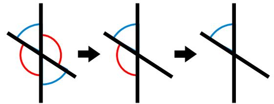
On considérera aussi que les cas présentés sur la figure ci-dessous sont équivalents, c'est-à-dire qu'un angle donné peut caractériser quatre configurations géométriques :
